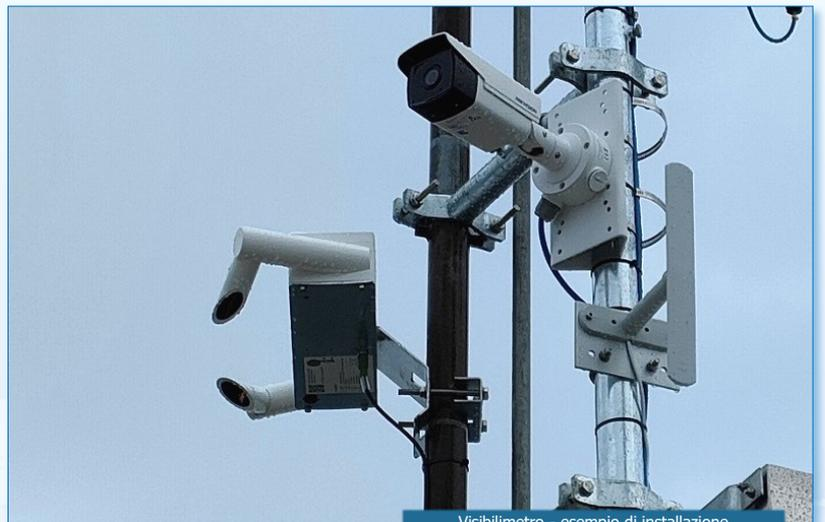
Visibilimetro - esempio di installazione
