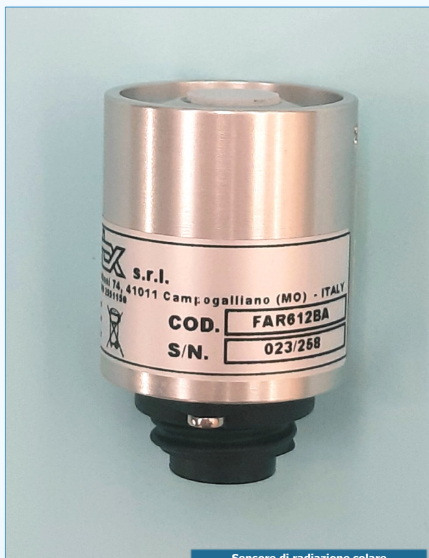
Sensore di radiazione solare
